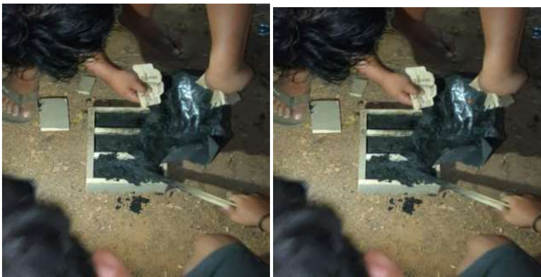
Gambar 2. Proses Pembuatan Con-blok dari Plastik
