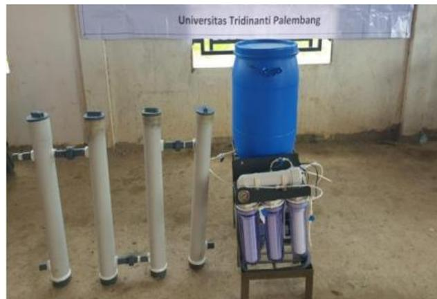
Gambar 4. Rangkaian alat reverse osmosis dengan 3 tabung
